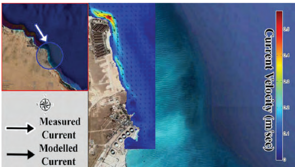
Figure 17 Calibration status for measuring currents in the study area Slika 17. Kalibracija za mjerenje struja u području istraživanja
